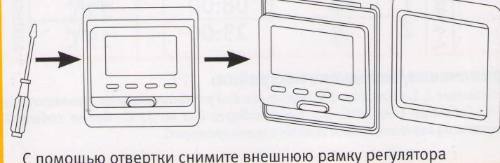
С помощью отвертки снимите внешнюю рамку регулятора
