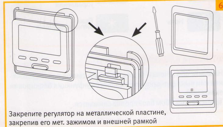
Закрепите регулятор на металлической пластине,
