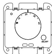
Снимите рамку с терморегулятора,
