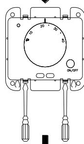
3А Используя две плоские отвертки, снимите центральную
