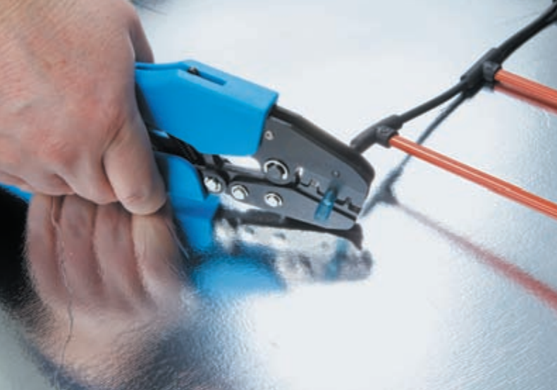
Рис. 7. Зажатие гильзы в термоусаживаемой трубке
