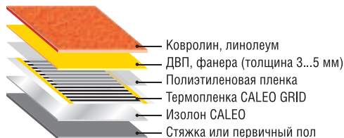
Рис. 4. Схема монтажа теплого пола CALEO под ламинат, ковролин, линолеум
