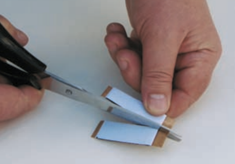
Рис. 11. Разрезание битумной изоляции на 2 части
