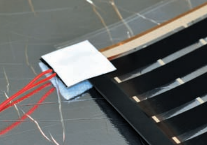
Рис. 20. Вид заизолированного контактного зажима с подключенными проводами
